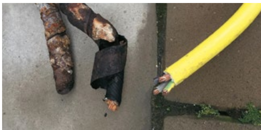
Bild 10. Skillnad mellan ny plastkabel och uttjänt järnbandskabel.
